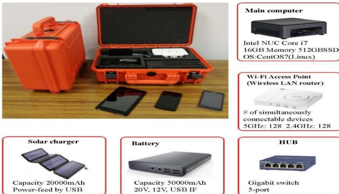
Figura 2.7. Equipamiento portátil Cloud-Edge para situaciones de emergencia.
