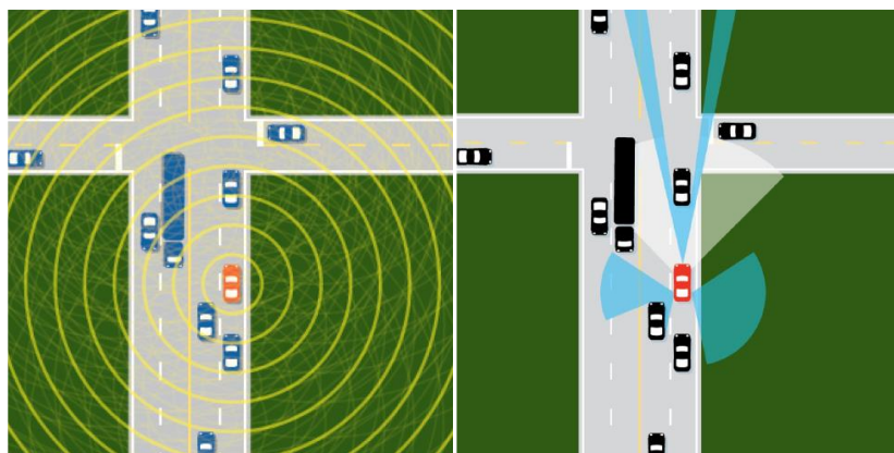
Figura 8.5. Sistema de seguridad basado en GPS y V2X (i) y sistema de seguridad convencional (d).
