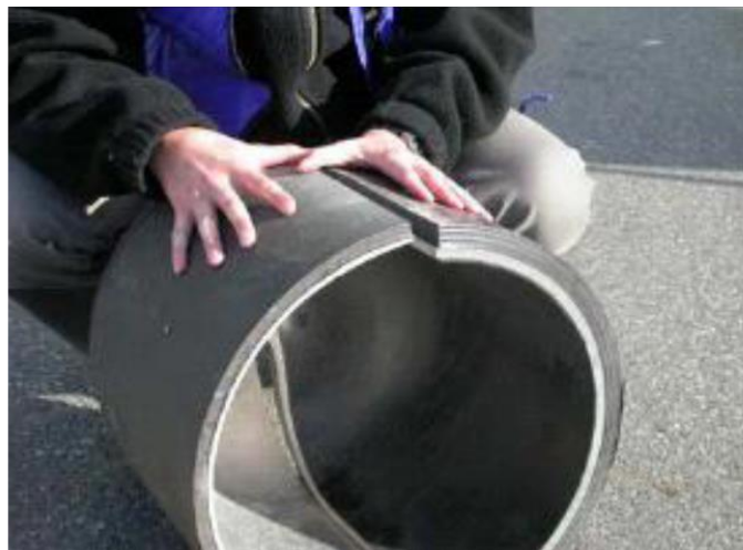
Figura 9.48. Diferencia de espesor en las paredes del depósito según la presión de almacenamiento: 35 ó 70 MPa.
